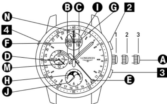
**A** 表冠**B** 时针**C** 分针**D** 小秒针**E** 日期指针**F** 星期视窗**G** 月份视窗**H** 月相**I** 30分钟计时盘**J** 12小时计时盘**M** 24小时 AM/PM (上午/下午) 指示器**N** 计时码表秒针**2** 开始/停止按钮。启动和停止计时码表指针和计时盘**3** 计时码表指针和计时盘复位按钮**4** 星期调校器
