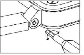
De 4 inbusschroeven (binnenzijde met diameter van 1,3 mm) houden de horlogeband vast op de bevestigingen van de kast. Het los- en vastdraaien van deze schroeven moet met zorg gebeuren en gebruik hierbij uitsluitend de 2 hiervoor bestemde gereedschappen die in het etui bij het horloge zijn geleverd.
