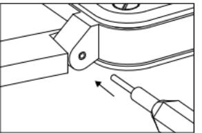
Uma haste de mola que serve para fixar o bracelete às asas da caixa. Esta haste deve ser retirada com cuidado, utilizando para isso a ferramenta adequada fornecida com o relógio, dentro do estojo.
