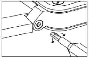
4개의 소켓 헤드 나사(육각 소켓/1.3 mm 직경)로 스트랩을 케이스 고정부에 고정합니다. 이 나사는 상자에 시계와 함께 들어 있는 2개의 공구를 사용해 조심스럽게 다루어야 합니다.
