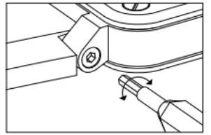
Mit den vier Hohlschrauben (sechskant / 1,3 mm Durchmesser) wird das Armband an den Bandanständen des Gehäuses befestigt. Diese Schrauben müssen vorsichtig mit den beiden zu diesem Zweck vorgesehenen, mit der Uhr in ihrer Schatulle gelieferten Werkzeugen manipuliert werden.
