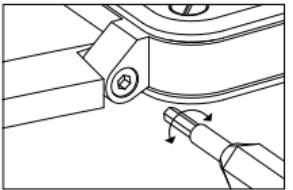
带隐形螺钉的连接件 (G)
