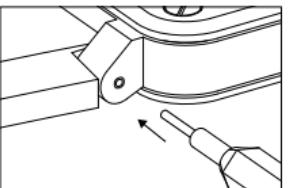
Une barrette à ressort sert à fixer le bracelet sur les attaches du boîtier. Cette barrette doit être extraite avec précaution en utilisant l'outil adéquat livré avec la montre dans son écrin.
