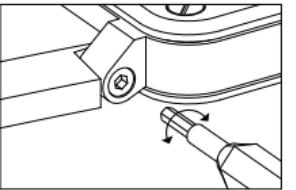
溝付きヘッドの 4 本のビス(6 角溝／直径 1.3 mm)でストラップをケースのアタッチメントに固定します。このビスは化粧箱の中にある時計に付属の 2 つの専用工具を使用して慎重に取扱う必要があります。
