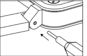
バネ棒でストラップをケースのアタッチメントに固定します。このバネ棒は化粧箱の中にある時計に付属の専用工具を使用して慎重に引き出す必要があります。
