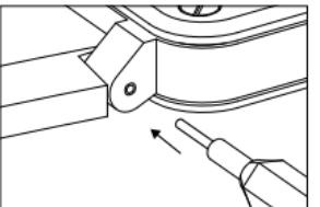
Una barrita con muelle sujetla la pulsera a las fijaciones de la caja. Esta barrita debe extraerse con precaución con la ayuda de la herramienta adecuada utilizada que se incluye en el estuche del reloj.
