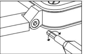
Los 4 tornillos con cabeza hueca (hendidura hexagonal/1,3 mm de diámetro) sirven para fijar la pulsera a las fijaciones de la caja. Estos tornillos deben manipularse con precaución utilizando las dos herramientas adecuadas incluidas en el estuche del reloj.
