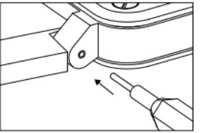
Een veerstift houdt de horlogeband vast aan de bevestigingspunten van de kast. Het verwijderen van deze stift moet met zorg gebeuren en gebruik hierbij uitsluitend het hiervoor bestemde gereedschap dat in het etui bij het horloge is geleverd.
