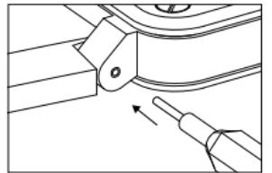
Das Armband wird mit einem Federsteg an den Bandanständen des Gehäuses befestigt. Dieser Steg muss mit dem zu diesem Zweck vorgesehenen, mit der Uhr in ihrer Schatulle gelieferten Werkzeug vorsichtig herausgezogen werden.
