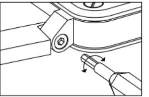
4 винта с шестигранным шлицем (шестигранный шлиц/диаметр 1,3 мм) предназначены для крепления ремешка к элементам крепления на корпусе. При вкручивании и выкручивании этих винтов следует использовать специальные приспособления, входящие в комплект поставки часов, и соблюдать особую осторожность.
