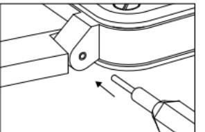
Пружинный фиксатор предназначен для крепления ремешка к элементам крепления на корпусе. При вытягивании этого фиксатора следует использовать специальное приспособление, входящее в комплект поставки часов, и соблюдать особую осторожность.
