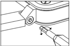
Le 4 viti a testa cava (testa esagonale incassata / 1,3 mm di diametro) servono a fissare il cinturino sugli attacchi della cassa. Queste viti devono essere maneggiate con cautela, utilizzando i 2 utensili speciali forniti nell'astuccio insieme all'orologio.
