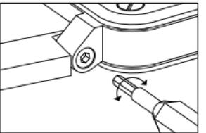
Os 4 parafusos de cabeça oca (cabeça oca hexagonal/1,3 mm de diâmetro) servem para fixar o bracelete nas asas da caixa. Estes parafusos devem ser manuseados com cuidado, utilizando as 2 ferramentas adequadas fornecidas com o relógio, dentro do estojo.
