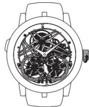
Votre montre est équipée d'un mouvement mécanique à remontage manuel. Ajustez la couronne en position 1 et remontez le mécanisme à fond. La réserve de marche est de 72 heures pour un remontage manuel optimal. Néanmoins, afin de garantir le parfait fonctionnement de votre montre, il est recommandé de la remonter une fois par jour.
