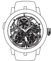
Jam tangan Anda dilengkapi dengan mesin penggerak pemutaran manual. Atur kenop utama jam tangan Anda ke posisi 1 dan putar mesin sepenuhnya. Cadangan tenaga adalah 72 jam dengan pemutaran manual optimal. Namun, kami menganjurkan pemutaran jam tangan Anda setidaknya sekali sehari untuk fungsi yang optimal.
