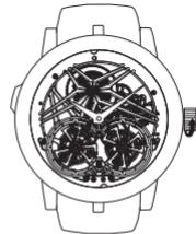
您的腕表搭载着手动上链机芯。请将表冠设于位置1，并手动上链至动力饱满状态。全面上链之后，腕表可具备72小时的动力储存。尽管如此，我们还是建议您每天为腕表上链一次，以确保最佳的功能运作。
