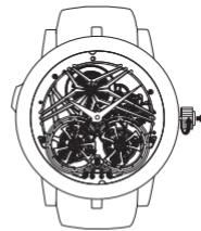
リューズをポジション2に引き出します。針を時計回りに回して時刻を合わせます。調整を終えたら、リューズをポジション1に押し戻します。
